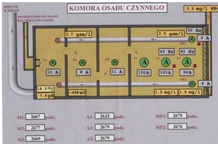
Rysunek 2. Schemat komory „C” osadu czynnego na OMB Elbląg.
